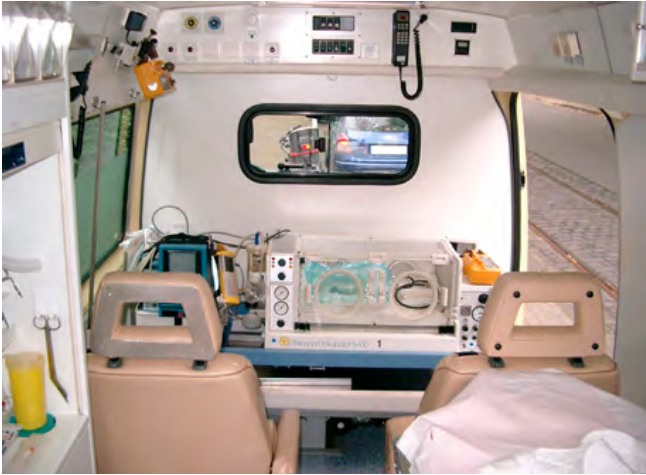
Der Inkubator ist quer zur Fahrtrichtung im Fahrzeug eingebaut und kann durch die seitliche Schiebetür entnommen werden.
